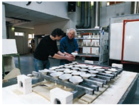
Pierluigi Pompei (links) en Kees Spanjers bouwen met zeer veel nauwkeurigheid een ovenplaat op.
